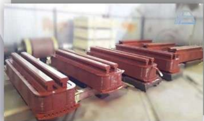
Полюса синхронного компенсатора КСВБ-100-11
