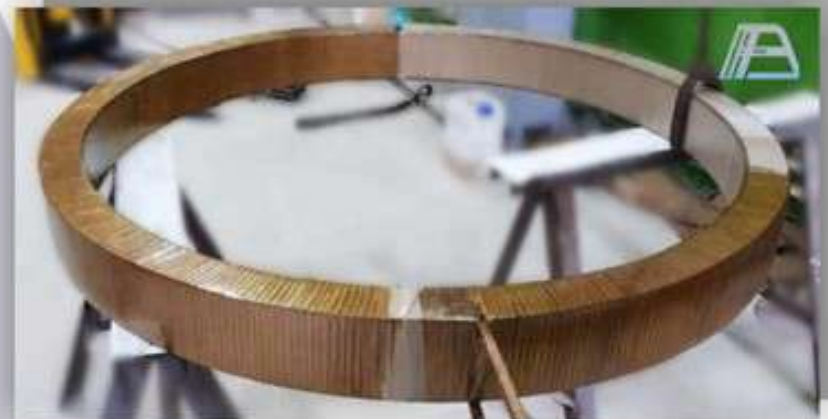
Катушка индукционного нагревателя ИНП-50 СЖ. Масса 427 кг
