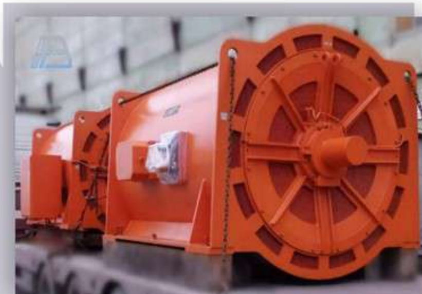
Капитальный ремонт Garbe-Lahmeyer ROA6131-85, 2200 кВт
