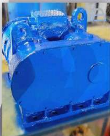
Ремонт вибровозбудителя вибромашины СО-266
