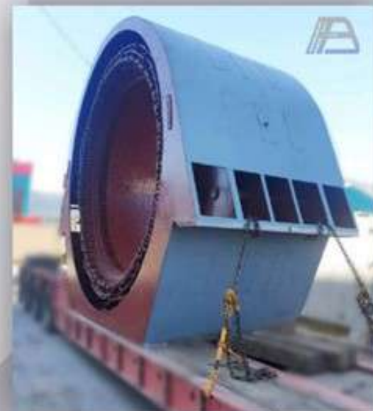
Капитальный ремонт статора СДСЗ-19-125-16, 18500 кВт, 10 кВ
