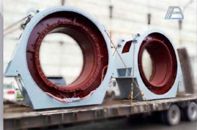
Капитальный ремонт статора СДМЗ-17-59-12, 3200 кВт, 6кВ
