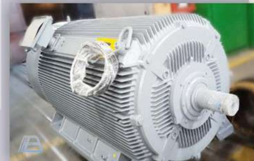
Капитальный ремонт SIEMENS 1LA7 635-4HF80Z, 800 кВт
