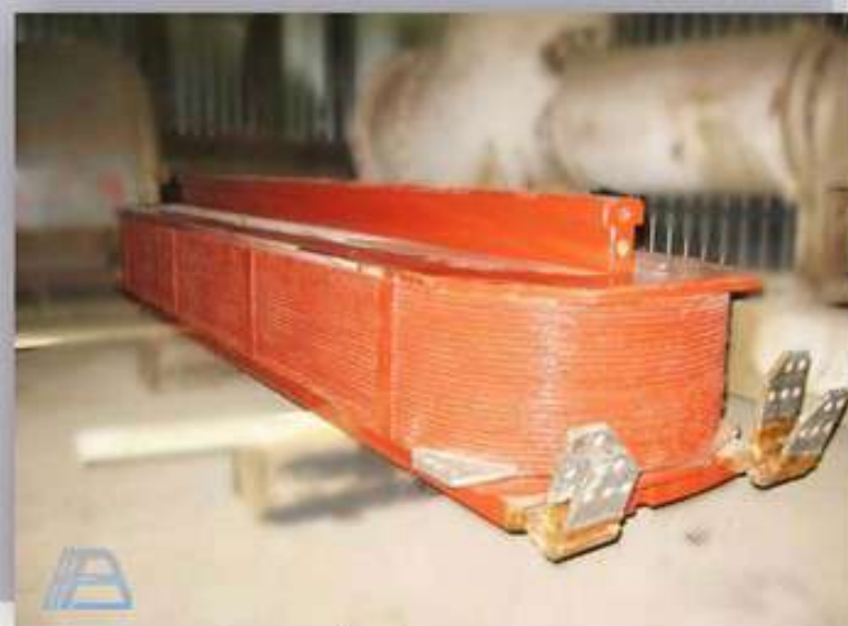
Полюс ротора гидрогенератора ВГДС-1025/245-40
