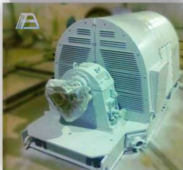
Капитальный ремонт STDМ-1250-2, 1250 кВт
