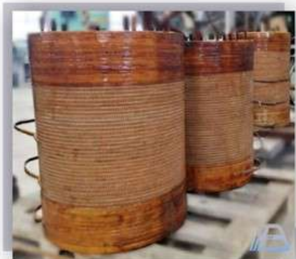
Катушка ВН и НН трансформатора ТСВП-630
