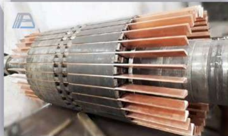
Капитальный ремонт ротора 2A3M-1000-6000, 1000 кВт, 1400 кг
