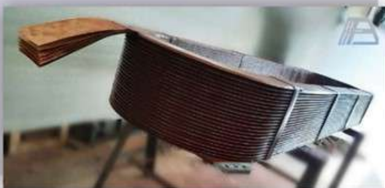
Катушка ротора гидрогенератора ВГДС-1025/245-40
