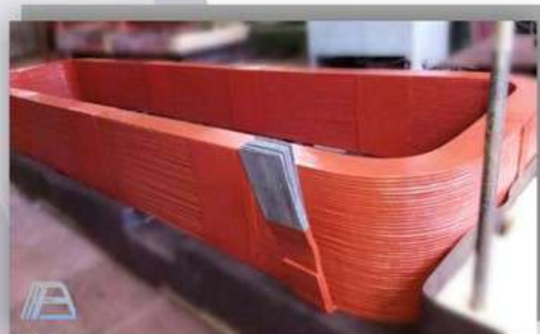
Катушка ротора синхронного компенсатора КСВБ-100-11
