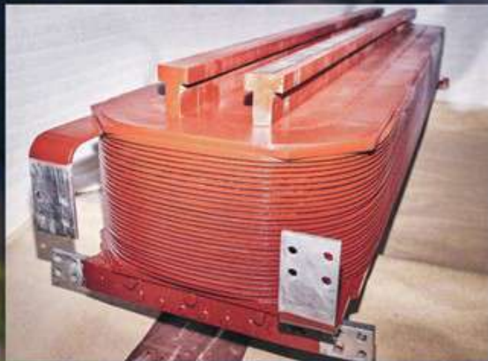
Полус ротора гидрогенератора СВ 1313/265-48 УХЛ4
