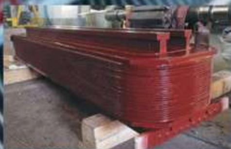
Полюс ротора гидрогенератора СВ 1313265-48 УХЛ4
