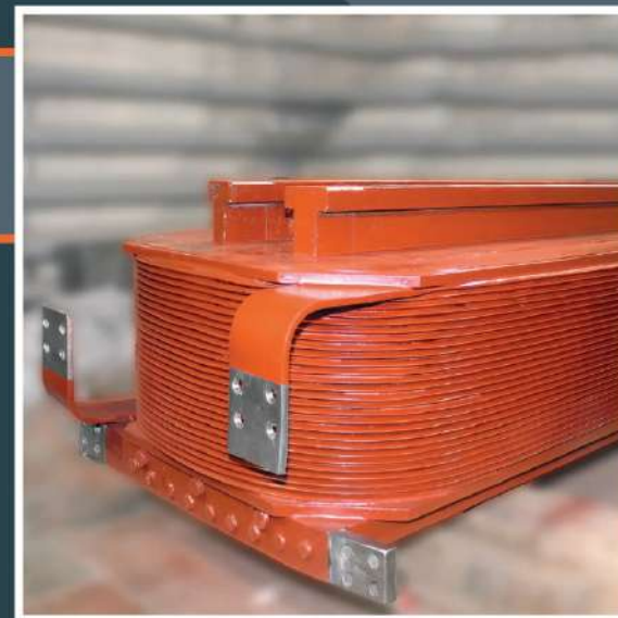
ПОЛЮС РОТОРА ГИДРОГЕНЕРАТОРА СВ 1313/265-48 УХЛ4
