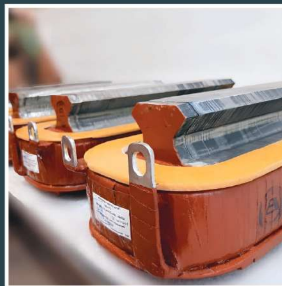
ПОЛЮС РОТОРА СГТ-1000 (800 кВт, 700/400В)
