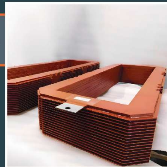
КАТУШКА SIEMENS 1DL69478ME02Z (19000кВт, 10000В, 1500 об/мин)
