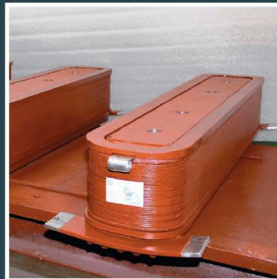
ПОЛЮС РОТОРА СДМЗ 2-21-91-40 (2500 кВт, 10000 В, 150 об/мин)
