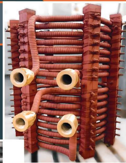
КАТУШКА ИНДУКТОРА ПЕЧИ УВС-2 d = 700мм
