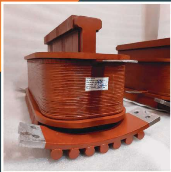
ПОЛЮС РОТОРА СДН 15-39-10 (1000 кВт, 55 В, 600 об/мин)
