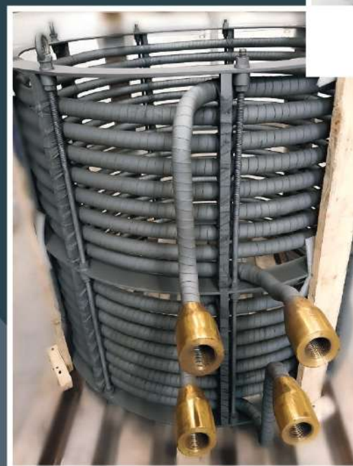
КАТУШКА ИНДУКТОРА ПЕЧИ УВС-2 d = 1100мм
