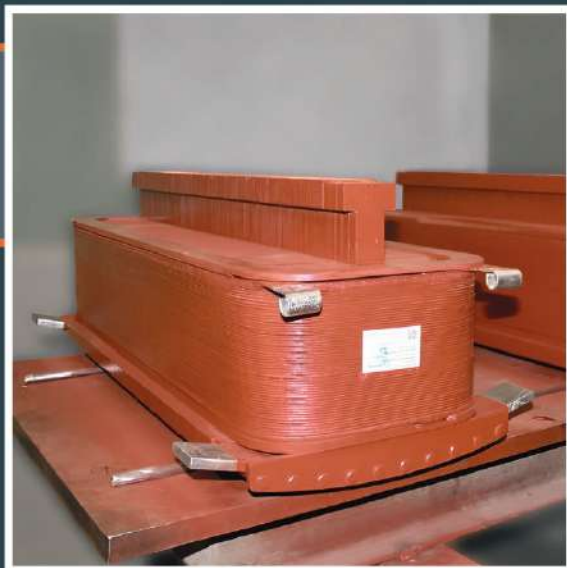
ПОЛЮС РОТОРА СДСЗ 17-76-12 УХЛ4 (3200 кВт, 92 В, 500 об/мин)
