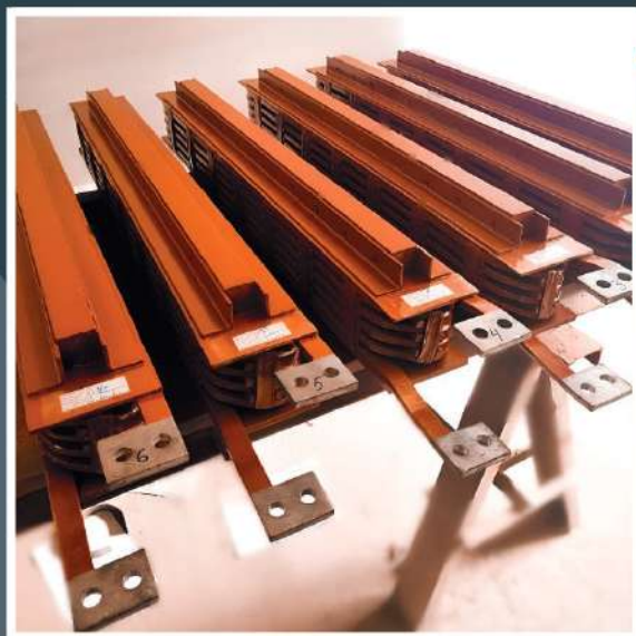
ДОПОЛНИТЕЛЬНЫЙ ПОЛЮС 2EZ 710 (597 кВт)
